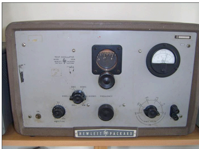
Figuur 1. Vooraanzicht van mijn exemplaar van de sinusgenerator HP650A, in werking!
